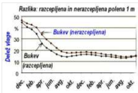
Slika 3; Zniževanje vlažnosti bukovih razcepljenih in nerazcepljenih drv v obdobju dveh let (Vir: TFZ Bayern)
